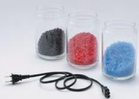
コンパウンドとは、主剤となる樹脂に、添加剤／顔料／他の樹脂等を混ぜ合わせ、新しい機能を持たせた複合材料です。主に押し出し成形、射出成型に使用されます。供給体制としては、共同開発・受託加工を中心としてお客様の要望に応じるカスタムメイドで対応させていただきます。
